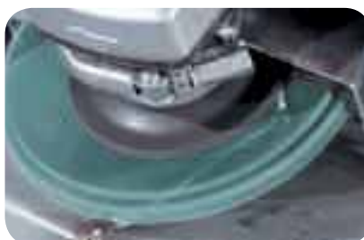
Благодаря трем «умным» выемкам LSZ F VISION обеспечивает свободный визуальный доступ к обрабатываемому изделию.
